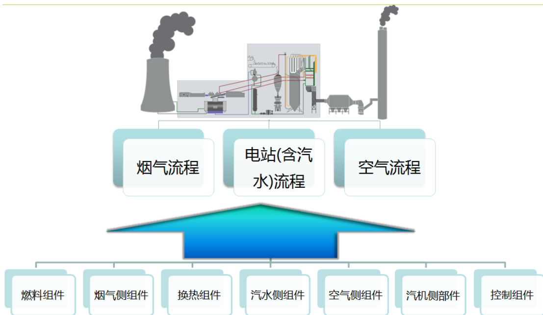
图 3 热力电站计算模型分解及构建
